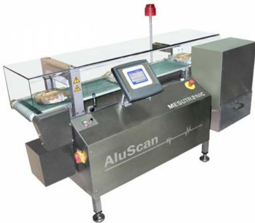
Herzstück der neuen Metalldetektorserie AluScan ist laut Dürrmeier ein intelligenter Magnetfeldflächensensor, der ausschließlich den Restmagnetismus von Metallverunreinigungen erfasst. Die zu untersuchenden Produkte werden am Bandeinlauf des Gerätes vormagnetisiert und dann über den Metallsensor geführt. Die nicht magnetisierbaren Aluminiumverpackungen sind für den Metallsensor somit unsichtbar. Verunreinigte Produkte werden erkannt und über eine Ausscheidklappe (Pusher
